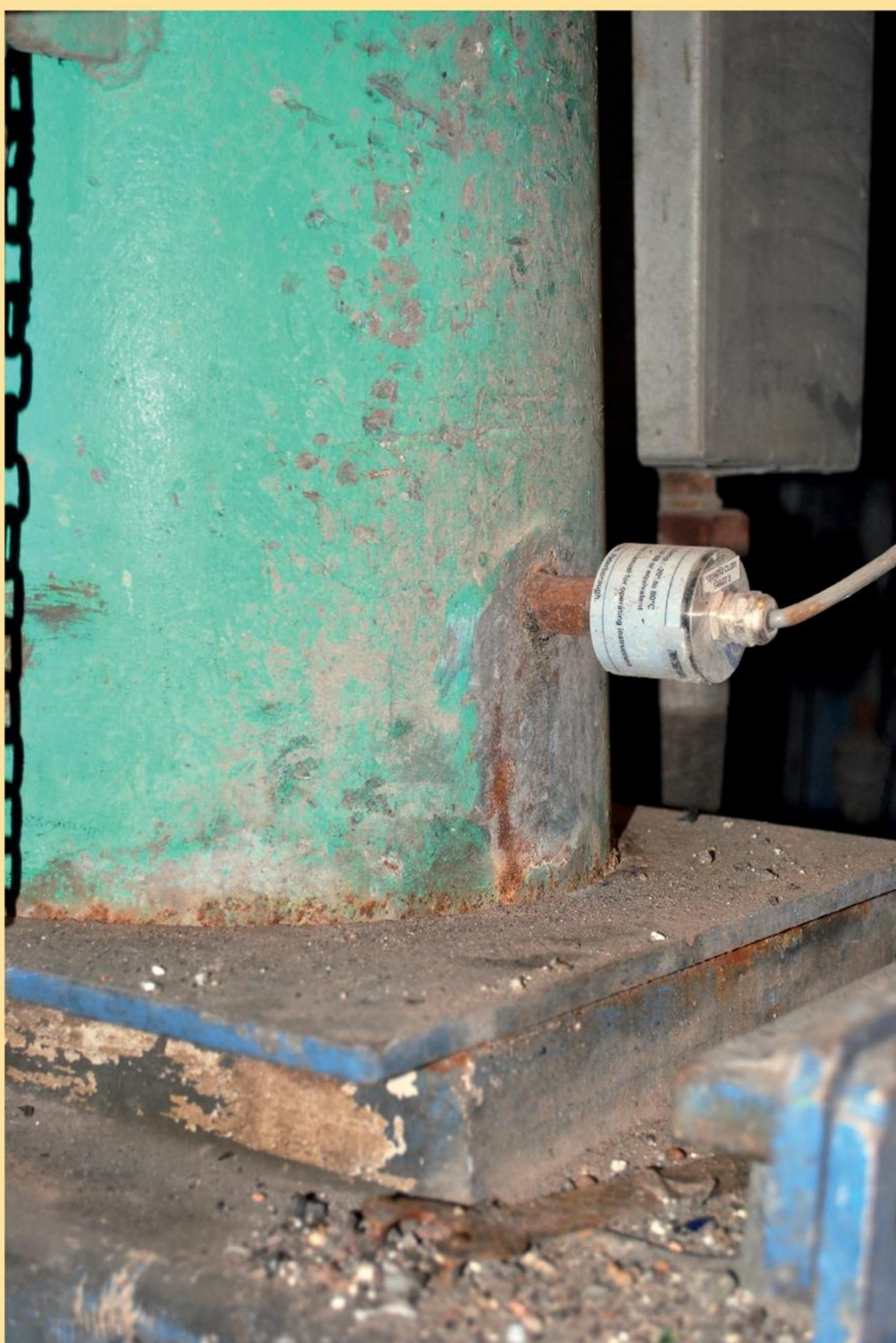
Nederst på hver opsamlingstragt er der placeret en akustisk sensor, der lytter til materialefaldet i røret.
